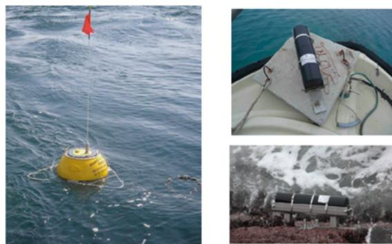
Pour la campagne 2014, les capteurs de pression immergés OSSSI ont fonctionné du 7 décembre 2013 au 3 mars 2014 pour les capteurs n° 1 (profondeur de -1 m CM (Côte Marine), et n° 2 (profondeur de 2 m CM) et du 1<sup>er</sup> mai à 30 juin 2014 pour le capteur n° 3 (profondeur de 8 m CM).
